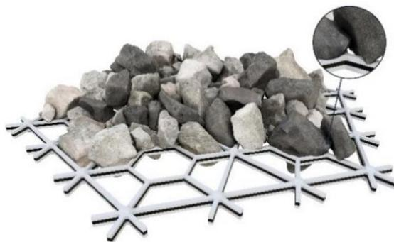
Abb. 5) Verzahnung des Korngerüstes in den Geogitteröffnungen (Tensar InterAx Geogitter)
